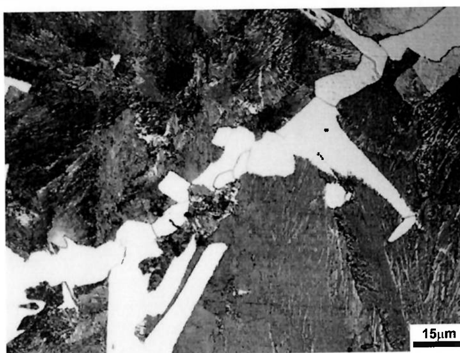
Figura 5.30 — — Micrografia Final da ZAC com ZF do Patim— Aumento 100X
