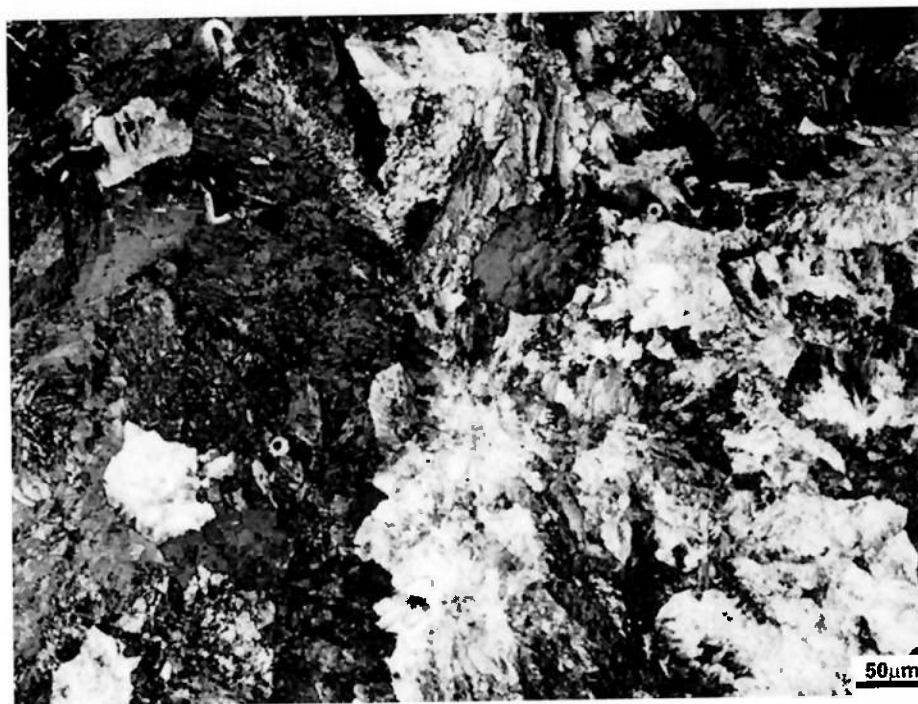
Figura 5.21 – Micrografia da ZF da Alma – Aumento 20X
