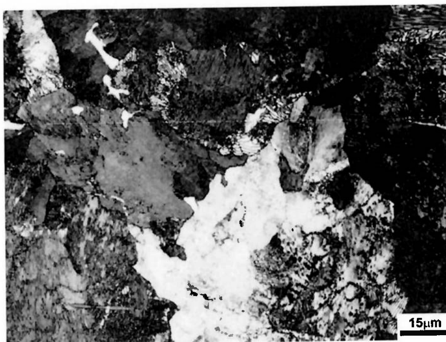
Figura 5.8 – Micrografia Centro da ZAC do Boleto – Aumento 100X
