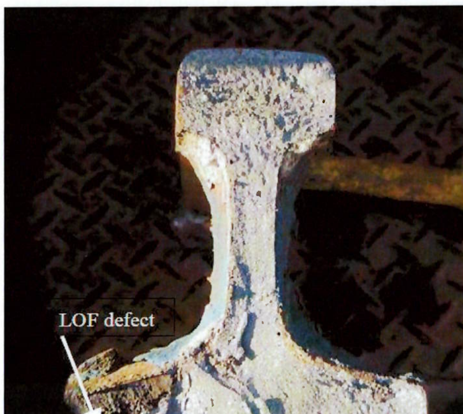
Figura 2.9 – Falta de fusão (WTIA,2006)
