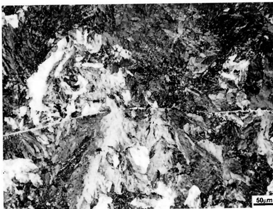
Figura 5.29 — Micrografia Final da ZAC com ZF do Patim— Aumento 20X
