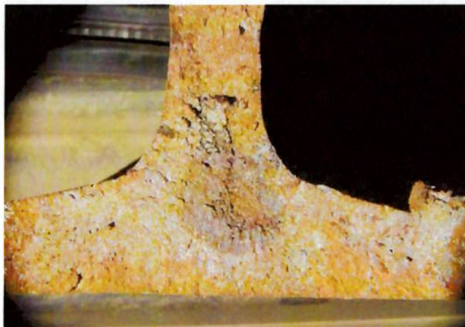
Figura 2.8 – Contração da solda (WTIA,2006)
