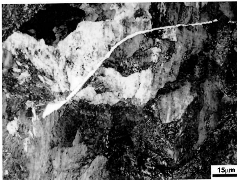
Figura 5.10 – Micrografia Final da ZAC com ZF do Boletão – Aumento 100X
