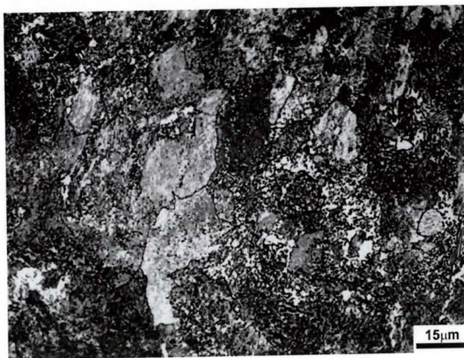
Figura 5.16 – Micrografia Início da ZAC da Alma – Aumento 100X
