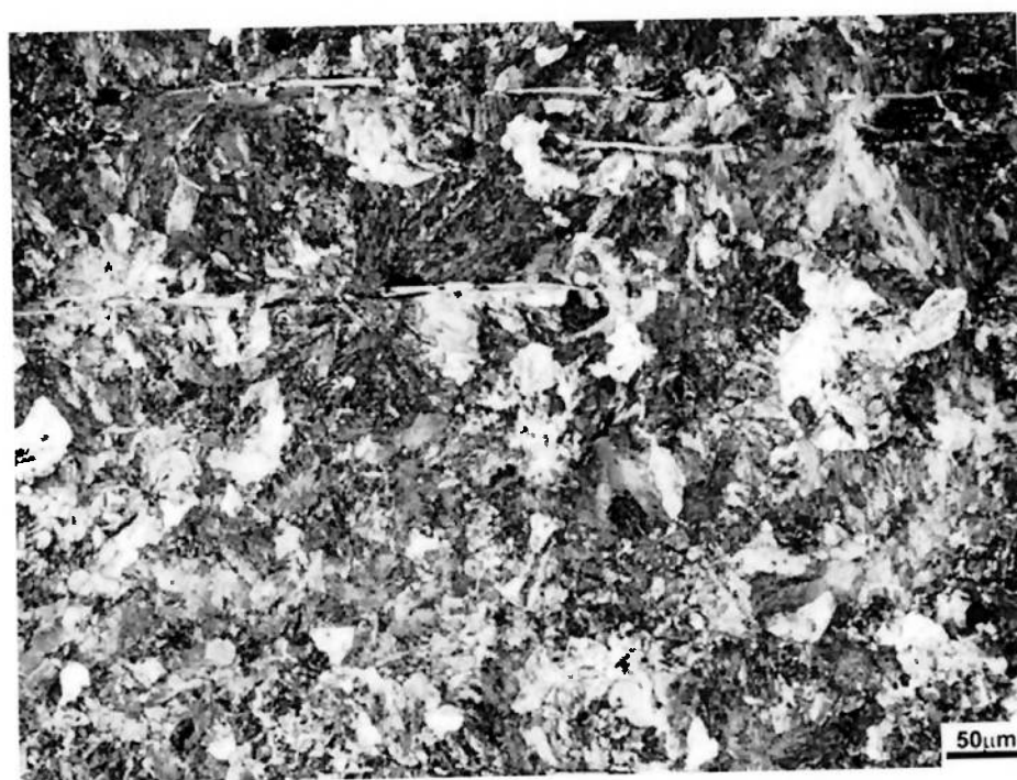
Figura 5.7 – Micrografia Centro da ZAC do Boileto – Aumento 20X
