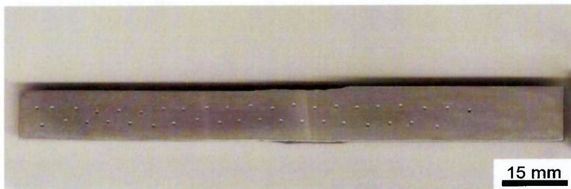
Figura 5.36 – Macrografia do Teste de Dureza Brinell da Alma
