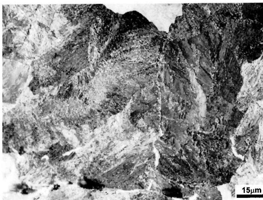
Figura 5.4 – Micrografia Metal de Base do Boleto – aumento 100X
