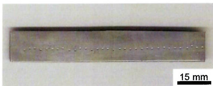
Figura 5.34 – Macrografia do Teste de Dureza Brinell do Boleto
